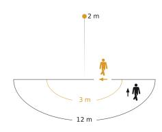
Hauteur d'instal lation: 1,80 m - 4,00 m Orange: sens de passage radial Noir: sens de passage tangentiel
